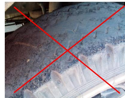
3. Отсутствие на автошинах боковых порезов, кусковых отрывов протекторов и др повреждений
