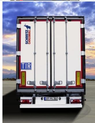
5. Должна соблюдаться исправность внешних световых и электрических приборов (в т. ч. звуковой и аварийной сигнализации). Необходимо попросить водителя включить фары ближнего и дальнего света, аварийную и звуковую сигнализации, проверить целостность осветительных приборов, включая сигнал заднего хода.
